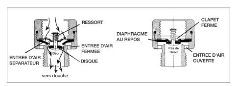
Ce disconnecteur d'extrémité assure une vidange de l'aval à l'arrêt du débit. Évite, en cas de dépression sur le réseau, tout retour d'eau polluée par une fuite éventuelle du clapet de non retour.
